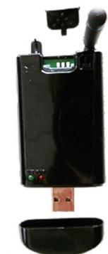
USB modem se používá pro odesílání SMS, hlasového volání a MMS upozornění přímo ze zařízení do mobilního telefonu nebo ze seznamu nastavených mobilních telefonů. Tento modem se zařízením RAMOS Ultra je samostatné řešení a nevyžadují další aplikace.
