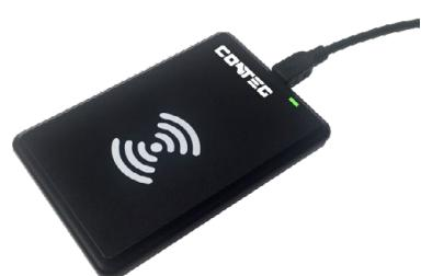
Stolní duální čtečka k PC je užitečným příslušenstvím pro administraci karet uživatelů v aplikaci CONTEG Pro Server. Pracuje na frekvenci 125 kHz a 13.56MHz. Je schopna pracovat s 125 kHz identifikačními přístupovými médií. Disponuje LED signalizací a bzučákem. Připojuje se k USB portu počítače, odkud je zároveň napájena.
