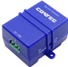
Adaptér umožňuje připojení externích analogových senzorů s výstupním signálem 0-10 V DC. Přepínač na straně adaptéru umožní přepnutí na vstupní /výstupní kontakt, který je schopen udržovat výstup 5 V DC pro napájení senzoru, a přitom po celou dobu sleduje vstupní kontakt. Toto zařízení se připojuje k hlavním monitorovacím jednotkám RAMOS Optimax.
