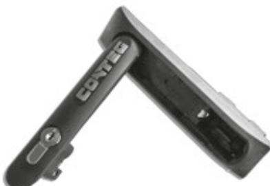
Elektronická klika je umístěna na dveřích samotného rozvaděče se standardním montážním otvorem 25 × 150 mm. Kliku s polo-cylindrickou vložkou lze otevřít pomocí klíče. Může být osazena na dveře s vícebodovým i jednobodovým zamýkacím mechanismem. Na těle klyky je umístěna LED signalizace indikující stav – odemčeno, zamčeno, otevřeno a vniknutí. Klika disponuje nízkou energetickou spotřebou, v běžném stavu méně než 50mA a v pracovním režimu méně než 250 mA, a je napájena z hlavní jednotky.
