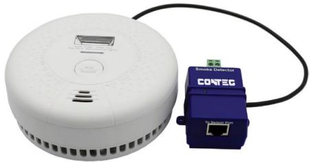
Kouřový detektor vydává 85 dB dvoustavový alarmový signál ve vzdálenosti 3 m od zařízení a dále je vybaven LED indikací. Instaluje se na strop pro maximální možnou detekci kouře. Detektor je napájen z hlavního zařízení a má zabudovanou záložní baterii. Připojení se provádí pomocí kabelu LAN CAT 5/6 s maximální délkou 150 m. Má zabudované zábleskové světlo, které upozorní na detekci kouře.
