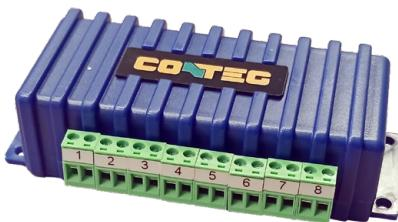
S expandérem je možné vytvořit 8 vstupů/výstupů na jediném inteligentním portu hlavní řídicí a monitorací jednotky. K tomuto expandéru je možné připojit na vstupním kontaktu jakýkoliv typ spínacího dveřního kontaktu (např. RMS-MK-01). Zařízení je automaticky rozpoznáno a napojeno z hlavní jednotky. Připojení se provádí pomocí standardního kabelu LAN CAT 5/6. Maximální délka prodloužení kabelu je 300 m.
