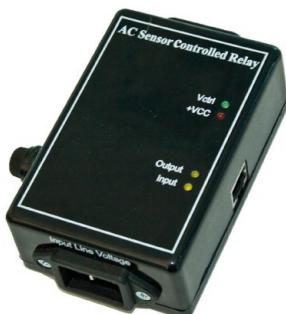
Rízený výstup umožňuje uživateli dálkově ovládat elektrické zařízení přes internet. Sleduje výkonové zatížení a přijímá kontrolní signál, který je odeslán z přístroje. Relé může být ovládáno pomocí zvoleného alarmu na senzoru. Relé je napájeno z hlavního zařízení. Vestavěná 10A pojistka. Konektor C13 a C14. Spínač může být ovládán libovolným senzorem. Připojení se provádí pomocí kabelu LAN CAT 5/6. Maximální délka připojovacího kabelu je 30 m.
