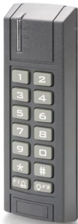
Podsvícená klávesnice se zabudovanou čtečkou karet (EM formát) umožňuje autorizaci pomocí karty samotné na 125 kHz nebo kombinaci karty s 4místným kódem. Snadné připojení k přístupové jednotce dveří RDU pomocí kabelu s barevně označeným konektorem RJ-45. Čtečka je vybavena bzučákem a LED signalizací pro indikaci stavu. Vhodná pro instalaci do vnitřních prostor. Nízká energetická spotřeba, v běžném stavu 65 mA. Napájení z hlavní jednotky.
