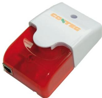
Siréna se zábleskovým světlem slouží jako vizuální a akustický alarm pro obsluhu. Vydává hlasitost až 100 dB ve vzdálenosti 1 m od zařízení a záblesky jsou v intervalu 400x za minutu. Zařízení má rozsáhlé možnosti nastavení, například vypnutí signalizace až po potvrzení přijeté informace. Siréna může být prodloužena až na 30 m za použití kabelu LAN CAT 5/6.
