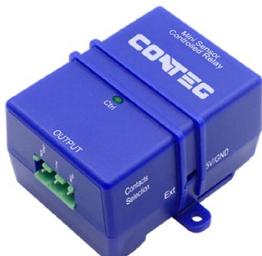
Mini relé box s volitelným napěťovým výstupem lze připojit k hlavní monitorovací jednotce RAMOS Optimax. Toto zařízení dokáže upravit napěťovou úroveň signálu, například zařízení s relé je možné přepnout na základě vstupu senzoru, potom bude tento výstup ze senzoru 200 mA – 5 V DC.
