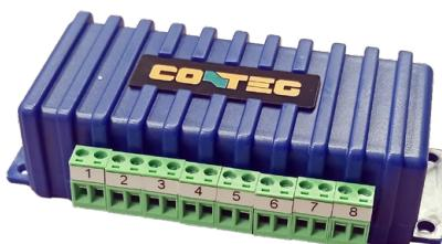
S expandérem je možné vytvořit 8 bezpotenciálových vstupů/výstupů na jediném intelligentním portu. Každý lze nastavit jako vstup, nebo výstup (výstup až 20 mA). K tomuto expandéru je možné připojit na vstupním kontaktu jakýkoliv typ spínacího dveřního kontaktu.
