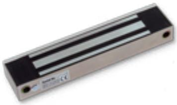
Vodotěsný elektromagnetický zámek dveří s přídružnou silou 3500 N, což odpovídá 350 kg, je vhodný k instalaci na vstupní dveře. LED indikace zámku zobrazuje stav - odemčeno, zamčeno, otevřeno nebo vniknutí. Napájen z hlavní jednotky.
