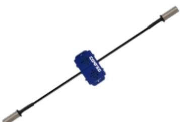
Senzory pro mapování rozvaděče jsou ideální pro kompletní monitorování prostředí v rozvaděčích. Pomocí senzorů je možné určit hotspots a přizpůsobit osazení IT hardwaru v rozvaděči či výkon chladicí jednotky. Před-zapojené senzory v jedné kabelové řadě měří ve 3 úrovních. Umožňují sledovat teplotu v horní, střední a dolní části stojanových rozvaděčů vpředu nebo vzadu, stejně jako teplotní rozdíl v jednotlivých úrovních (hodnota  $\Delta T$ ).
