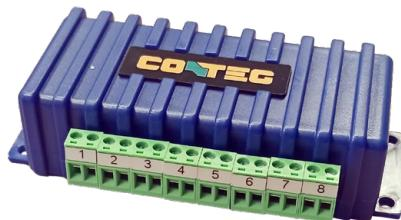
S expandérem je možné vytvořit 8 bezpotenciálových vstupů/výstupů na jediném inteligentním portu. Každý lze nastavit jako vstup, nebo výstup (výstup až 20 mA) K tomuto expandéru je možné připojit na vstupním kontaktu jakýkoliv typ spínacího dveřního kontaktu. Expandér je napájen z hlavního zařízení. Připojení se provádí pomocí kabelu LAN CAT 5/6. Maximální délka prodloužení kabelu je 300 m.
