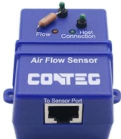
Senzor detekuje přítomnost či absenci proudícího vzduchu uvnitř rozvaděče. Čidlo funguje na principu diferenčního měření, kdy se porovnává odpor vnějšího a vnitřního termistoru. Toto zařízení je možné propojit s alarmovou reakcí a může být prodloužen až na 30 m za použití kabelu LAN CAT 5/6.
