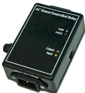
Řízený výstup umožňuje uživateli dálkově ovládat elektrické zařízení přes internet. Sleduje výkonové zatížení a přijímá kontrolní signál, který je odeslán z přístroje. Relé může být ovládáno pomocí zvoleného alarmu na senzoru. Relé je napájeno z hlavního zařízení. Vestavěná 10A pojistka. Konektor C13 a C14. Spínač může být ovládán libovolným senzorem. Připojení se provádí pomocí kabelu LAN CAT 5/6. Maximální délka připojovacího kabelu je 30 m.
