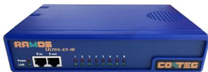
RAMOS ULTRA-EX-18 je rozšiřující modul s 8 inteligentními porty pro příslušenství. Lze ho připojit ke všem rozšiřujícím portům umístěných na předním panelu základních jednotek RAMOS Ultra, RAMOS Ultra ACS nebo RAMOS Optimax. Jsou připojeny pomocí standardního LAN kabelu CAT5.
