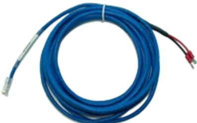
Vstupní/výstupní kontakt slouží k připojení externích zařízení, například zabezpečovacích či požárních systémů, nebo jakékoli aplikace, která vyžaduje kontrolu ze strany jednotky. Při použití jako výstup může dodávat až 20 mA. Rozsah vstupního napájení je 0 až 5 V. Kontakt je napájen z hlavního zařízení. Prodloužení se provádí pomocí kabelu LAN CAT 5/6 a spojky RJ45-RJ45 (kategorie 5e) RMS-I-CON. Maximální délka prodlužujícího kabelu je 300 m.
