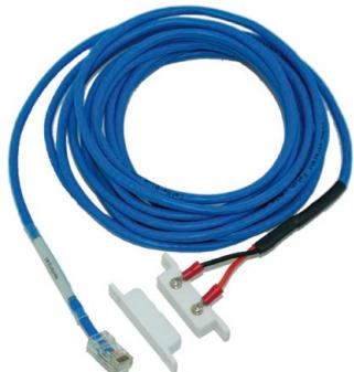
Magnetický kontakt slouží jako monitorovací prvek, který sleduje otevření rozvaděče. Lze sledovat nejen nepovolené otevření dveří, ale i bočních panelů. Kontakt je napájen z hlavního zařízení. Prodloužení se provádí pomocí kabelu LAN CAT 5/6 a spojky RJ45-RJ45 (kategorie 5e) RMS-I-CON. Maximální délka prodlužujícího kabelu je 300 m.
