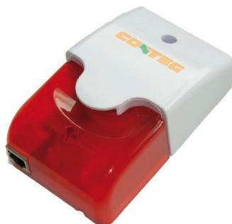
Siréna se zábleskovým světlem slouží jako vizuální a akustický alarm pro obsluhu. Vydává hlasitost až 100 dB ve vzdálenosti 1 m od zařízení a záblesky jsou v intervalu 400x za minutu. Zařízení má rozsáhlé možnosti nastavení, například vypnutí signalizace až po potvrzení přijetí informace. Siréna může být prodloužena až na 30 m za použití kabelu LAN CAT 5/6.
