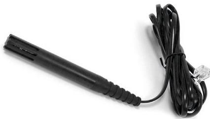
Senzor snímá teplotu a vlhkost uvnitř rozvaděče. Připojuje se pomocí 2,5 m dlouhého kabelu přímo do monitorovaného, nebo řízeného napájecího panelu. Po připojení senzoru k napájecímu panelu (konektor RJ12) je čidlo automaticky detekováno a naměřené parametry prostředí jsou k dispozici na web serveru i přes SNMP. Černá barva.
