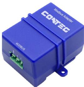
Pomocí adaptéru lze převést port MOD/EXP na hlavní monitorovací jednotce RAMOS Optimax na sériový Modbus port.
