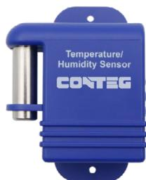
Senzor teploty a vlhkosti v pouzdře pro umístění dovnitř do rozvaděčů snímá teplotu s rozsahem -55 °C až +75 °C a vlhkost s rozsahem 0–100 %. Senzor může být prodloužen až na 300 m za použití kabelu LAN CAT 5/6.
