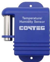
Senzor teploty a vlhkosti v pouzdře pro umístění dovnitř do rozvaděče snímá teplotu s rozsahem -55 °C až +75 °C a vlhkost s rozsahem 0–100 %. Senzor může být prodloužen až na 300 m za použití kabelu LAN CAT 5/6.
