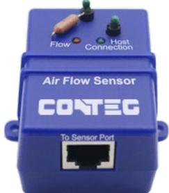
Senzor detekuje přítomnost či absenci proudícího vzduchu uvnitř rozvaděče. Čidlo funguje na principu diferenčního měření, kdy se porovnává odporník vnějšího a vnitřního termistoru. Toto zařízení je možné propojit s alarmovou reakcí a může být prodloužen až na 30 m za použití kabelu LAN CAT 5/6.
