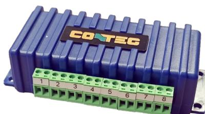
S expandérem je možné vytvořit 8 bezpotenciálových vstupů/výstupů na jediném inteligentním portu. Každý lze nastavit jako vstup, nebo výstup (výstup až 20 mA). K tomuto expandéru je možné připojit na vstupním kontaktu jakýkoliv typ spínacího dveřního kontaktu. Expandér je napájen z hlavního zařízení. Připojení se provádí pomocí kabelu LAN CAT 5/6. Maximální prodloužení kabelu je 300 m.
