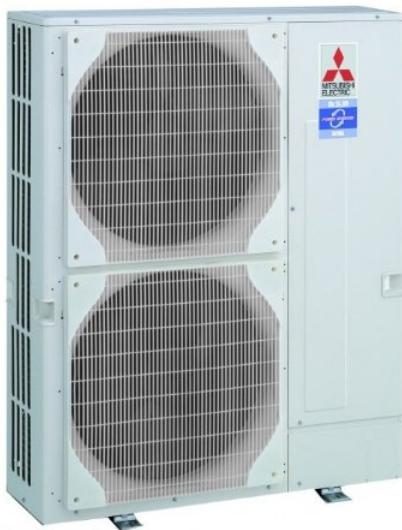
Chladicí jednotku CoolTop DX lze připojit až ke 2 **venkovním kondenzačním jednotkám**, které obsahují veškeré řídící prvky (komprezor, expanzní ventil, frekvenční měnič). Jednotky jsou osazeny scroll kompresorem, který pracuje s chladivem R410A.
