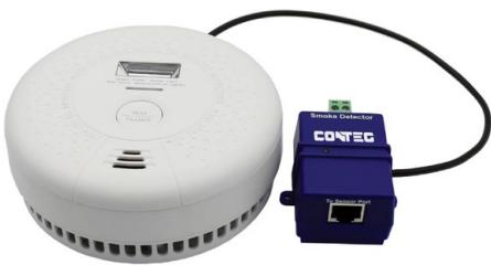
Kouřový detektor vydává 85 dB dvoustavový alarmový signál ve vzdálenosti 3 m od zařízení a dále je vybaven LED indikací. Instaluje se na strop pro maximální možnou detekci kouře. Detektor je napájen z hlavního zařízení a má zabudovanou záložní baterii. Připojení se provádí pomocí kabelu LAN CAT 5/6 s maximální délkou 150 m. Má zabudované zábleskové světlo, které upozorní na detekci kouře.
