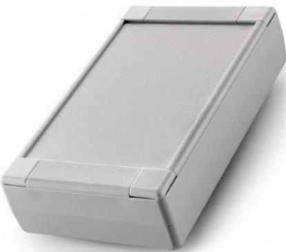
► Univerzální krabice pro elektroniku **Serie 70** ve vysoce odolném provedení splňují různé požadavky na použití v průmyslu, elektronice a kancelářské automatizaci. Jsou vyrobeny z vysoké kvalitního, vysoce odolného ABS, umožňují vynikající mechanizaci a jsou odolné vůči teplotám až do 85 °C. S těsnicím EPDM O-kroužkem splňují krytí IP65 z hlediska prachu a vlhkosti.
