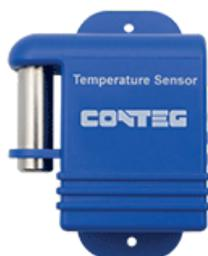
Le capteur de température est conçu pour une installation dans les baies et mesure la température dans la plage de -55°C à +75°C. Jusqu'à 8 capteurs peuvent être chaînés liés à un simple port intelligent. Le capteur est alimenté par l'unité principale. L'extension est faite en utilisant un câble LAN CAT 5/6 standard. La longueur maximum d'extension de câble est de 150m pour 8 capteurs.
