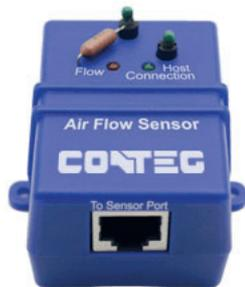
Этот датчик контролирует наличие/отсутствие воздушного потока в шкафу. Датчик работает по принципу дифференциального измерения (сравнение сопротивления наружного и внутреннего термистора). Устройство можно подключить к системе аварийной сигнализации; возможно удлинение до 30 м с помощью LAN-кабеля кат. 5/6.
