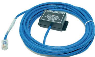
Точечный датчик затопления способен обнаруживать воду на месте установки. Датчик оснащён светодиодным индикатором статуса. Удлинение производится с помощью стандартного LAN-кабеля кат. 5/6. Максимальная длина кабеля — 60 м.
