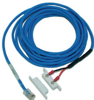
Магнитный дверной контакт является устройством безопасности, с помощью которого можно отслеживать несанкционированное открытие дверей и боковых панелей. Контакт запитывается от контроллера. Удлинение осуществляется с помощью стандартного сетевого шнура кат. 5/6 и муфты RJ45-RJ45 кат. 5e (артикул — RMS-I-CON). Максимальная длина кабеля — 300 м.
