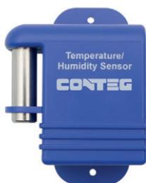
Датчик температуры и влажности в корпусе предназначен для размещения в шкафу и измеряет температуру в диапазоне от -55 до +75 °С, а влажность — в диапазоне от 0 до 100 %. Удлинение производится с помощью LAN-кабеля кат. 5/6; максимальная длина — 300 м.
