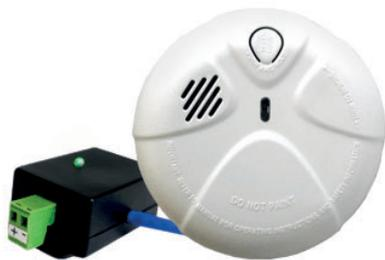
Датчик дыма выдаёт сигнал тревоги с двумя состояниями (85 дБ на расстоянии 3 м); также имеется светодиодный индикатор. Датчик требуется устанавливать на потолке, чтобы он мог обнаруживать дым наилучшим образом. Питание датчика производится от контроллера; в датчик дыма можно установить батарею резервного питания 9 В. Датчик подключается с помощью стандартного LAN-кабеля категории 5/6; максимальная длина кабеля — 90 м.
