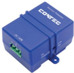
Этот адаптер позволяет подключить аналоговый датчик стороннего производителя с напряжением 0...10 В постоянного тока на выходе. Тумблер на боковой стороне адаптера даёт возможность переключиться на "сухой" контакт I/O, способный непрерывно поддерживать выходное напряжение 5 В постоянного тока для питания датчика и при этом осуществлять мониторинг на входе типа "сухой контакт". Адаптер подключается к контроллеру Optimax.
