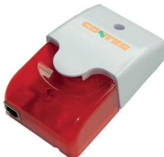
Сирена и проблесковый маячок выдают визуальный и звуковой сигнал тревоги для оператора. Сирена издаёт резкий, громкий звук (до 100 дБ на расстоянии 1 м), в то время как маячок мерцает с частотой 400 раз в минуту. Устройство имеет большое количество опций для настройки, к примеру, настройка условий для прекращения сигнала тревоги. Удлинение производится с помощью стандартного LAN-кабеля кат. 5/6. Максимальное удлинение — до 30 м.
