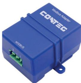
Адаптер преобразует разъём «Modbus/порт расширения» контроллера RAMOS Optimax в порт для последовательного протокола Modbus. Контроллер RAMOS Optimax оснащён комбинированным разъёмом «RS485 Modbus / порт расширения». Адаптер Modbus RTU служит для подключения устройств Modbus к порту RJ45, преобразуя его в клеммный блок с 3 «пинами» и тем самым позволяя присоединить к нему 2-жильный кабель последовательной шины данных.
