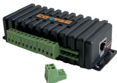
Этот модуль расширения оснащён 8 "сухими" контактами и подключается к интеллектуальному порту контроллера. Каждый контакт настраивается как вход или выход (в качестве выхода контакт выдаёт до 20 мА). Ко входам модуля расширения можно подключить дверные контакты любого типа. Устройство автоматически распознаётся контроллером. Питание модуля расширения производится от контроллера. Модуль подключается с помощью стандартного LAN-кабеля кат. 5/6. Максимальная длина кабеля составляет 300 м.
