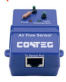
La capteur détecte la présence ou l'absence de débit d'air à l'intérieur des baies. La capteur fonctionne sur le principe de mesure différencielle, qui compare la résistance de la thermistance externe et interne. Cet appareil peut être connecté à une réponse d'alarme et peut être étendu jusqu'à 30m en utilisant un câble LAN CAT 5/6.
