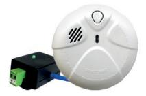
Le détecteur émet un signal d'alarme à 2 états de 85dB à une distance de 3m de l'unité et est également équipé d'une indication LED. Il doit être monté au plafond pour une détection maximale de la fumée. Cet appareil est alimenté par l'unité principale et peut être connecté à une batterie de secours de 9V. Il est connecté en utilisant un câble LAN CAT 5/6 standard avec une longueur maximum de connexion de 90m.
