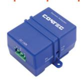
L'adaptateur de capteur rend facile la connexion d'un capteur analogique tiers avec une sortie O-10 V DC. Un interrupteur sur le côté du capteur vous permet de changer un contact sec I/O à la place, qui est capable de maintenir une sortie 5V DC pour alimenter le capteur tout le temps, tout en surveillant encore l'entrée du contact sec. Cet appareil est pluggé aux unités principales de monitoring OptimaX.
