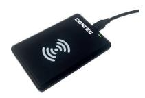
Настольный двойной считыватель прокси-карт, предназначенный для подключения к компьютеру, является полезным аксессуаром для настройки прав доступа в программе CONTEG Pro Server. Считыватель работает на частотах 125 кГц и 13,56 МГц и оснащён светодиодным и звуковым индикатором. Считыватель подключается к USB-порту компьютера, через который также осуществляется его электропитание.
