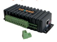
Этот модуль расширения оснащён 8 «сухими контактами» (вход/выход) и подключается к интеллектуальному порту контроллера/модуля RDU. Ко входам модуля расширения можно подключить дверные контакты (например, RMS-MK-01). Устройство автоматически распознаётся контроллером. Питание модуля расширения производится от контроллера. Модуль подключается с помощью стандартного LAN-кабеля кат. 5/6. Максимальная длина кабеля составляет 300 м.
