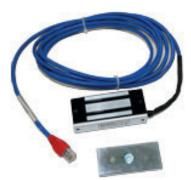
Малый электромагнитный дверной замок с силой зажима, равной 700 H (соответствует 70 кг), подходит для шкафов, которые нельзя оснастить электронными замками CONTEG. Светодиодный индикатор показывает статус замка: закрыт, открыт, удерживается открытым либо открыт принудительно. Питание замка производится от контроллера.
